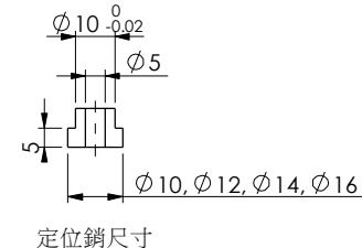
4x Ø16 可搭配他牌拉栓使用於定位盤
